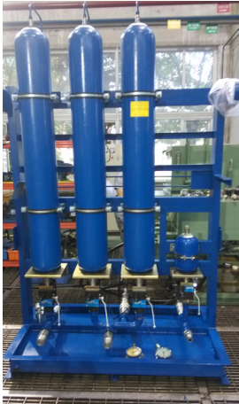
用于特种试验机液压系统的囊式蓄能器组。其中不同的容积及使用压力的蓄能器分别作用于进油路（100L）、回油路（50L）、先导控制路（4L）实现稳压及能量供给等功能。
